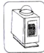
Registra en forma continua la radiación solar global incidente sobre una superficie horizontal, en calorías por centímetro cuadrado. Su elemento sensible son dos placas bimetalicas de diferente coeficiente de dilatación.
