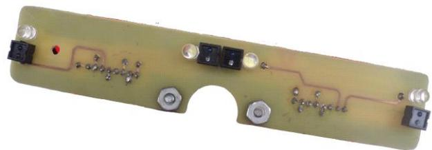
Figura 11. Fotografía de la tarjeta de sensores CNY-70
