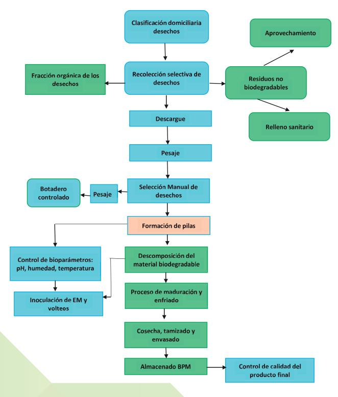
Ilustración 32 Flujograma para el procedimiento de compostaje Fuente: MAE-PNGIDS (2019)
