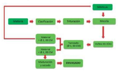
**Ilustración 20** Diagrama del proceso de degradación de la materia orgánica **Fuente:** GADM de MORONA, JICA, 2019
