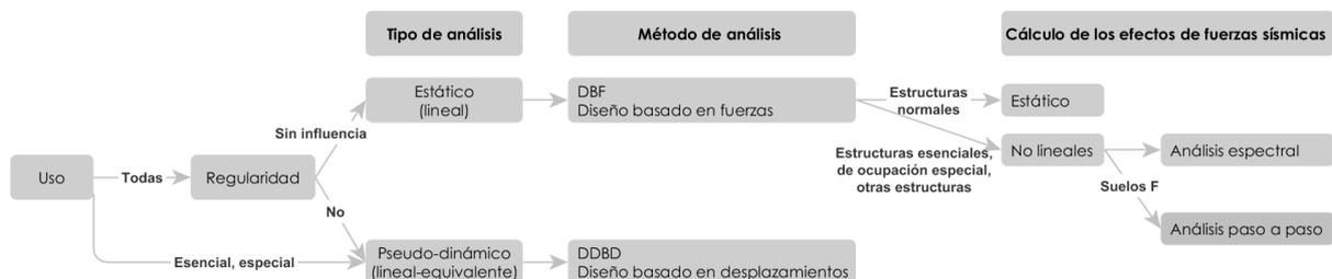
Figura 9: Vista general de los métodos de análisis de la NEC-SE-DS
