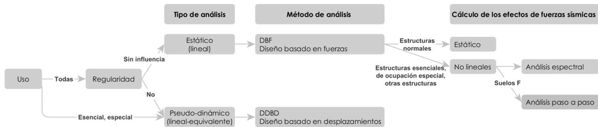
Figura 6 : Vista general de los métodos de análisis de la NEC-SE-DS
