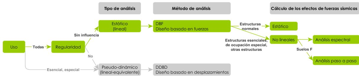
Figura 8 : DBF en los métodos de análisis de la NEC-SE-DS
