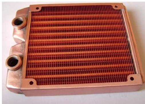
Figura 2.13 El radiador de cobre de coche
