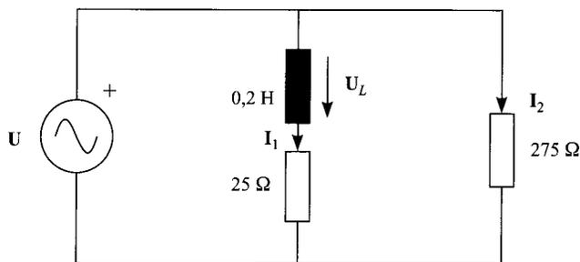
Se indica en el enunciado que la tensión pasa por un máximo cuando se produce la maniobra. Si se toma este instante como origen de tiempos, queda determinado el valor de  $\varphi$ , que tendrá el valor nulo para que se cumpla esta condición. Por consiguiente, el fasor asociado a esta tensión será:
