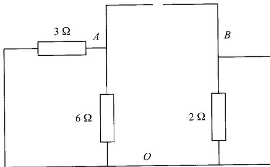
La resistencia equivalente es la resultante de asociar en serie la resistencia de  $2 \Omega$ , y el paralelo de las de  $6 \Omega$  y  $3 \Omega$ . El valor, por tanto, será de  $R_{th} = 4 \Omega$ .
