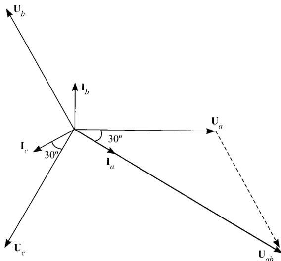
La corriente de la fase *c* está retrasada  $30^\circ$  respecto a la tensión. De la figura se observa que la tensión  $U_{ab}$  está adelantada  $90^\circ$  con respecto a la tensión  $U_c$ , luego el ángulo formado por  $I_c$  y  $U_{ab}$  es  $120^\circ$ . La medida del vatímetro es, por tanto:
