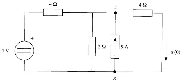
Una forma sencilla de obtener esta tensión es utilizando el método de superposición. La tensión  $u(0)$  es idéntica a la tensión en la fuente de corriente y la resistencia de  $2 \Omega$ . Si sólo actuase la fuente de corriente, la tensión en esta resistencia sería el resultado de multiplicar el valor de la fuente de corriente por el paralelo de la resistencia de  $2 \Omega$  con la de  $4 \Omega$ , es decir:
