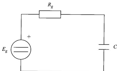
Una vez cargado, se produce la descarga de este condensador a través de la resistencia del «flash»:
