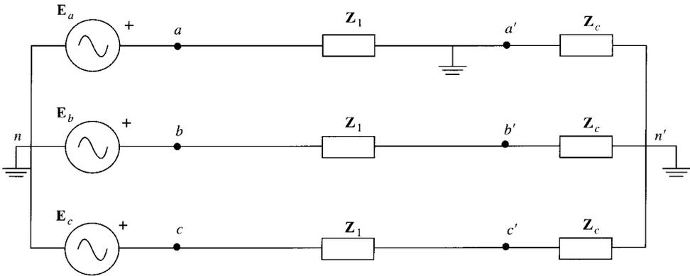
Si se unen todos los puntos a la misma tensión, se obtiene el circuito equivalente siguiente:
