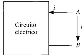
Figura 1.2. Dipolo con referencias de potencia entrante.
