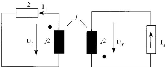
Ecuaciones de las bobinas acopladas:
