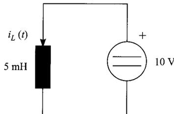
En este circuito (en el que se ha eliminado la resistencia en paralelo con la fuente de tensión que no produce ningún efecto en el circuito), la aplicación de una tensión constante a una bobina ideal hace que la corriente en ésta suba con una pendiente constante, a partir de un valor cero, puesto que está inicialmente descargada:
