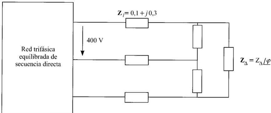
Para hallar el valor de la impedancia  $Z_{\Delta}$  es conveniente realizar el equivalente monofásico fase-neutro, que se muestra a continuación:
