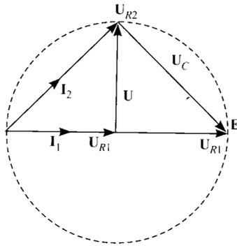
Para que  $\mathbf{E}$  y  $\mathbf{U}$  estén desfasadas  $90^\circ$  se tiene que cumplir la igualdad de las tensiones de  $R_2$  y  $C$ :
