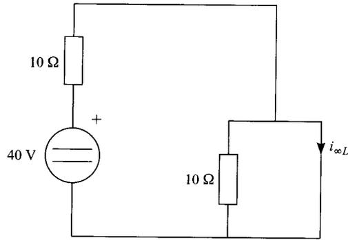
Puesto que por la resistencia de  $10\ \Omega$  en paralelo con un cortocircuito no circulará ninguna corriente,  $i_{\infty L} = 40/10 = 4\ \text{A}$ .
