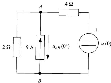
La fuente de tensión representa el condensador, cargado a su tensión inicial, que será la tensión que hay en el condensador justo antes de la maniobra de apertura, y que a su vez se obtiene en el siguiente circuito:
