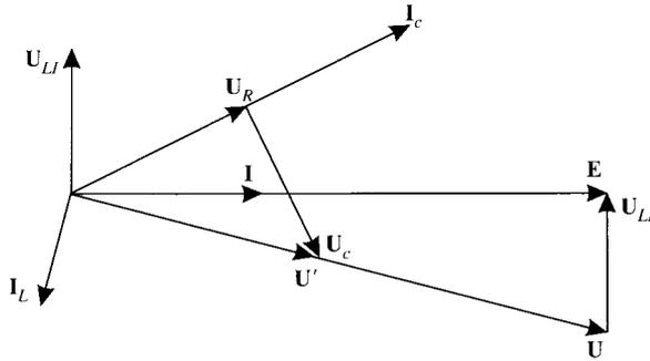
A la vista del diagrama vectorial, el valor eficaz de  $E$  se puede calcular conociendo la tensión de la bobina  $L_1$ :
