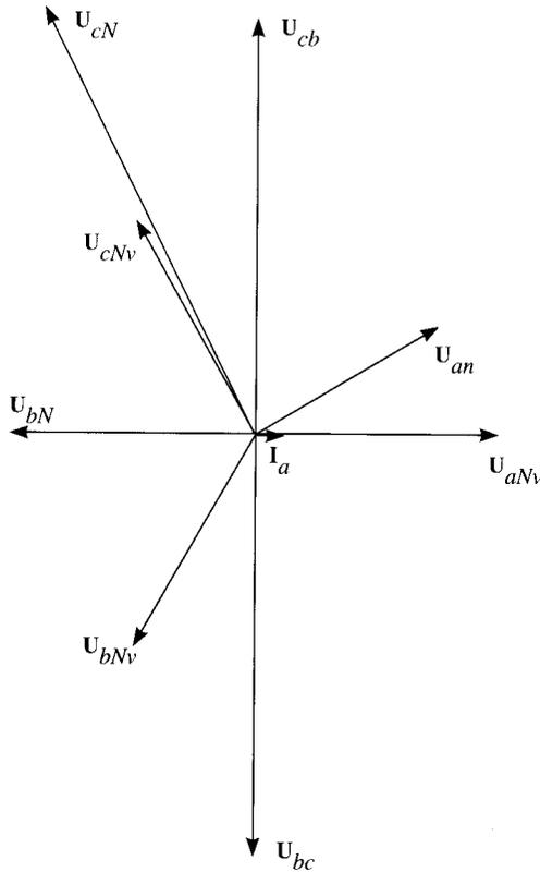
El sistema trifásico de secuencia directa de la figura, es equilibrado en las tensiones de entrada. Este sistema trifásico, de frecuencia 50 Hz y tensión de línea 380 V alimenta una carga de tipo inductivo conectada en triángulo. En estas condiciones, la lectura del amperímetro A es de 4 A y la del vatímetro W de 912 W. Se pide:
