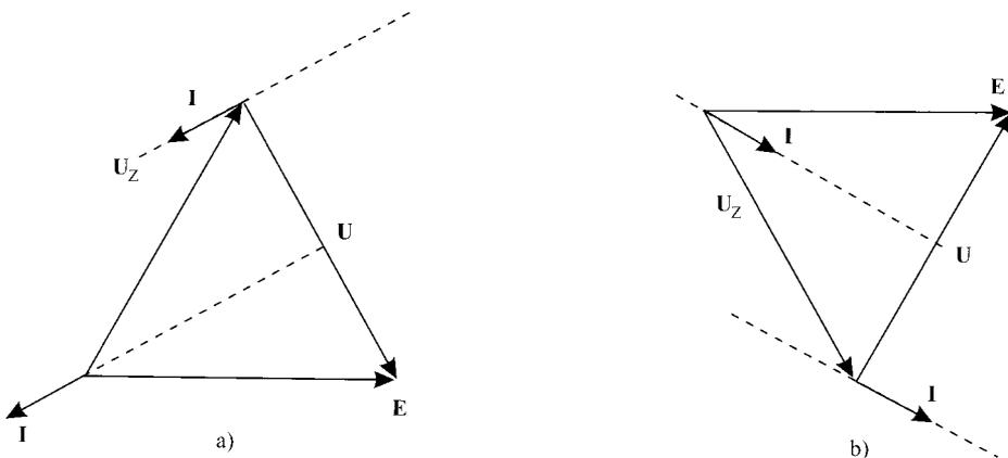
Como la impedancia  $Z_1$  es inductiva, la corriente  $I$  debe estar retrasada  $90^\circ$  con respecto a la tensión  $U$ . En la primera figura esto es imposible, pues en tal caso la tensión de la fuente y la corriente formarían un ángulo mayor de  $90^\circ$ . En cambio en el diagrama b) la tensión de la fuente y la corriente forman un ángulo menor de  $90^\circ$ . Por tanto, se elige la segunda opción.
