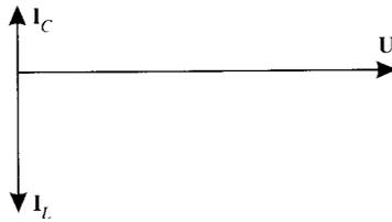
Si  $I$  es la corriente por la resistencia, se debe cumplir que  $I = I_L + I_C$ , luego  $I$  estará en fase con  $I_L$  y su valor eficaz será igual al de  $I_C$ . Completando el diagrama anterior con corriente y tensión en la resistencia y en la fuente se tiene:
