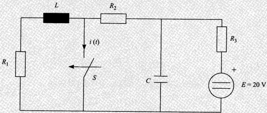
Nota: para el cálculo de  $i(t)$  téngase en cuenta que al cerrar el interruptor  $S$  los circuitos  $R_1-L$  y  $E-R_2-R_3-C$  son circuitos de primer orden e independientes.
