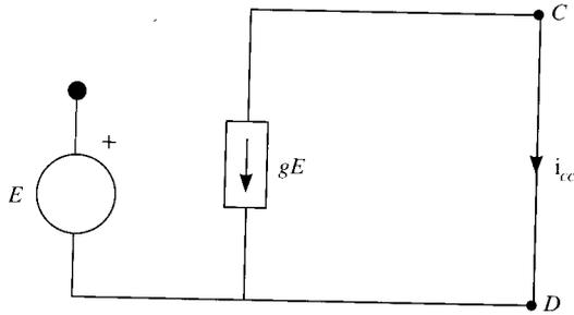
La resistencia Thévenin a partir de la tensión de vacío y de la corriente de cortocircuito es:
