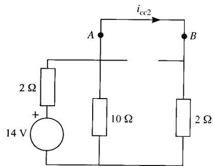
En el primer circuito,  $i_{cc1} = 1$  A. Para hallar  $i_{cc2}$  en el segundo circuito, se transforma la fuente de tensión real en fuente de corriente real, y se asocian las resistencias en paralelo:
