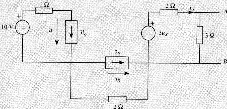
Obtener el equivalente Thévenin del circuito de la figura con respecto a los terminales A y B. Comprobar la solución.
