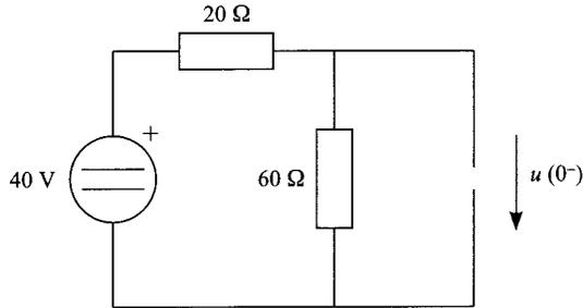
La tensión en la resistencia de  $60 \Omega$  se puede hallar teniendo en cuenta que, con el condensador como un circuito abierto, las dos resistencias están en serie, y se puede utilizar la fórmula del divisor de tensión. Por consiguiente:
