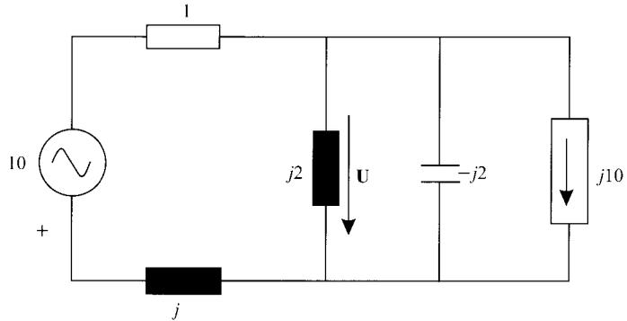
Para realizar su resolución por el método de mallas, se va a cambiar la fuente de corriente en paralelo con un condensador, por una fuente de tensión en serie con el mismo condensador. Si  $I_2 = j10$ ,  $E_2 = I_2 \cdot (-j/\omega C) = j10 \cdot (-j2) = 20$ .
