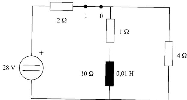
Puesto que en régimen permanente, y en corriente continua, una bobina se comporta como un cortocircuito, la corriente que circulará por ella se obtendrá del circuito siguiente:
