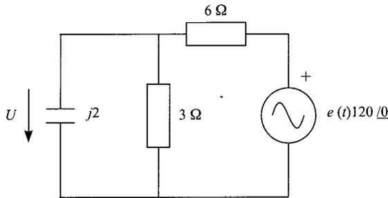
La tensión en el condensador se puede obtener aplicando la fórmula del divisor de tensión al paralelo de la resistencia de  $3 \Omega$  y del condensador, en serie con la resistencia de  $6 \Omega$ . Esto proporciona un valor de tensión:
