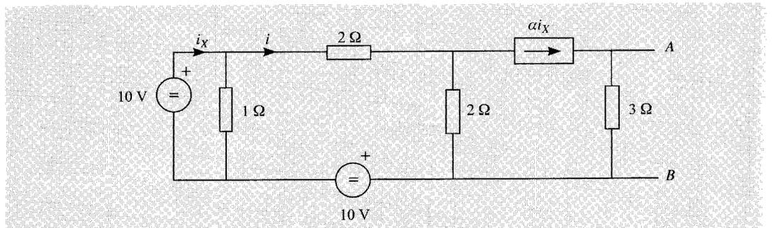
Obtener el equivalente Thévenin del circuito de la figura con respecto a los puntos  $A$  y  $B$ . Datos:  $\alpha = 1$ .
