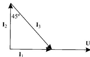
Las otras dos corrientes vienen dadas, puesto que los desfases relativos están impuestos por las impedancias ( $I_2$  debe estar adelantada  $90^\circ$  respecto a la tensión, e  $I_3$  retrasada  $45^\circ$  respecto a la misma tensión) y el hecho de que  $I_2 + I_3 = I_1$ . Esto permite deducir los valores de las corrientes.
