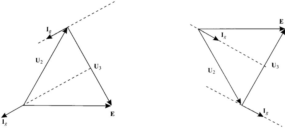
La corriente  $I_g$  es la que circula por la bobina, luego dicha corriente debe estar retrasada  $90^\circ$  con respecto a la tensión  $U_3$ . En la primera figura esto es imposible, pues en tal caso la tensión de la fuente y su corriente formarían un ángulo mayor de  $90^\circ$ . Por tanto, se elige la segunda opción.
