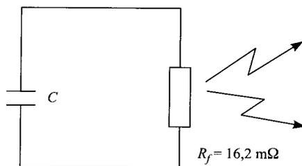
1. Para que el valor de  $C$  sea el mínimo posible, en la carga y en la descarga se debe alcanzar el régimen permanente. Un condensador mayor también almacenaría la energía necesaria en este tiempo, sin necesidad de que se alcanzase el régimen permanente.
