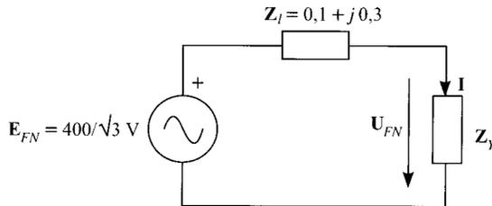
en el que la impedancia  $Z_Y$  toma el valor  $Z_Y = Z_{\Delta}/3 = Z_Y/\varphi$ , y  $\varphi$  es el ángulo de la impedancia  $Z_{\Delta}$  que vendrá dado por su factor de potencia
