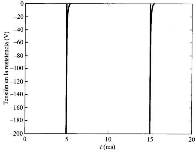
4.14. En el circuito de la figura el interruptor  $S$  conecta los puntos  $A$  y  $C$  en el instante  $t = 0$ . Al cabo de 10 ms, el interruptor pasa a conectar los puntos  $B$  y  $C$ ; 10 ms más tarde, vuelve a conectar  $A$  y  $C$ , y así sucesivamente.
