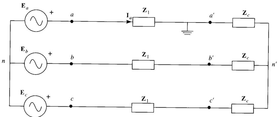
La corriente  $I_a$  no resulta alterada por la presencia del cortocircuito, pues por él no se puede derivar corriente, al tratarse del único punto que está conectado a tierra. La corriente por esta fase, valdrá, por tanto:
