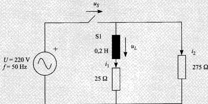
Expresar y dibujar las formas de onda de  $i_1$ ,  $i_2$  y  $u_L$  desde 20 ms antes de la apertura del interruptor hasta 5 ms después de dicha apertura, suponiendo que la fuente es sinusoidal de valor eficaz 220 V, y que en el instante de abrirse el interruptor la tensión de la fuente pasaba por un máximo. Obténgase también la tensión en el interruptor,  $u_s$ .
