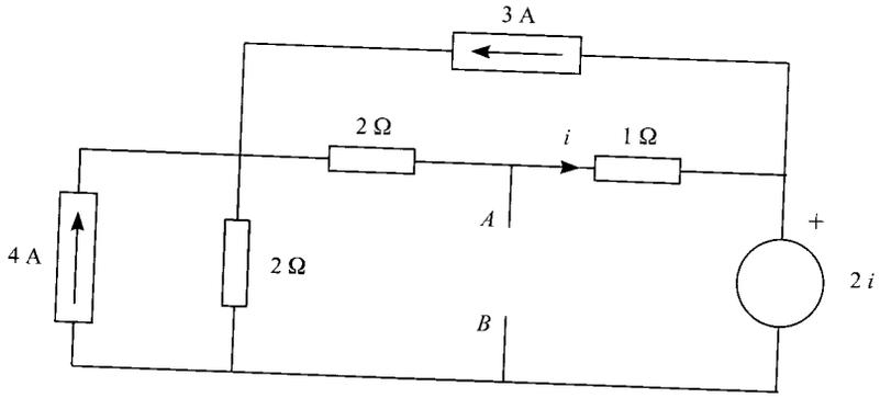
En este circuito se procederá a hallar los valores de la fuente y de la resistencia. La tensión en vacío, entre los terminales  $A$  y  $B$  se puede obtener, bien aplicando el método de mallas o nudos, bien modificando el circuito para simplificarlo. Si se escoge este último, es necesario transformar las fuentes de la forma siguiente:
