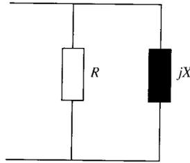
Una bobina de 6,322 mH está conectada a una fuente de tensión sinusoidal de 50 Hz y 4 V de valor eficaz. Determinar:
