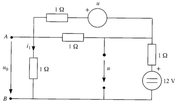
La tensión a circuito abierto,  $u_0$ , es precisamente la tensión entre los terminales A y B:
