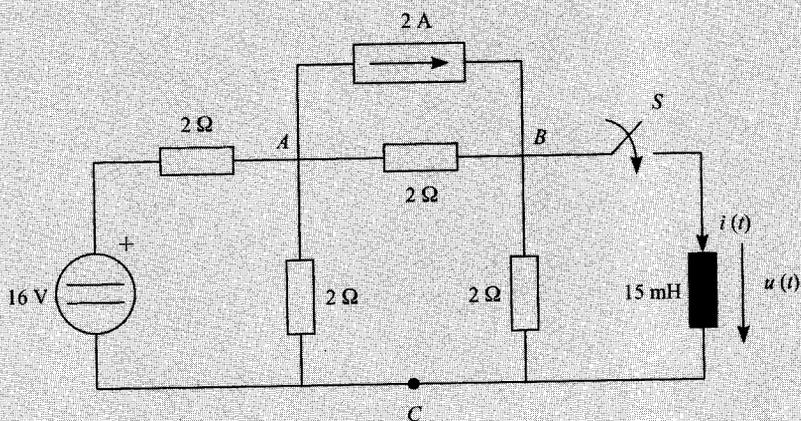
a) Con el interruptor  $S$  abierto, obténgase el equivalente Thévenin del circuito desde los terminales  $BC$ .
