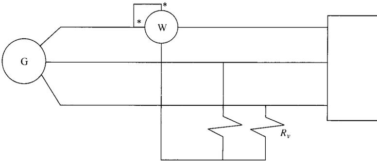
$R_v$  es la resistencia de la bobina voltimétrica del vatímetro.
