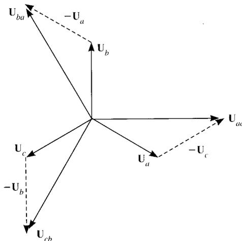
En esta figura se puede comprobar que el sistema es de secuencia inversa, y que la tensión  $U_a$  tiene un argumento de  $-30^\circ$ , tomando como referencia la tensión  $U_{ac}$ . En cuanto a las impedancias, tanto de la fuente como de la carga, deberán dividirse entre 3 para obtener su valor equivalente en estrella. Esto se muestra en el circuito que aparece a continuación:
