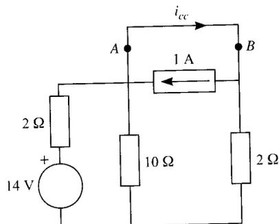
Se calcula  $i_{cc}$  aplicando el principio de superposición:
