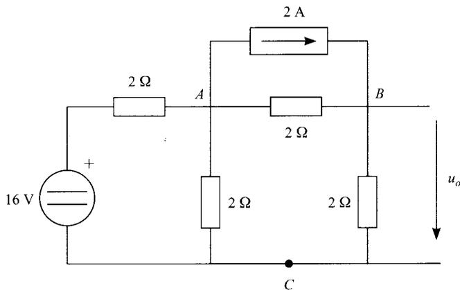
Una forma de obtener esta tensión es empleando el método de superposición. Cuando sólo actúa la fuente de corriente, la tensión entre  $B$  y  $C$ ,  $u'_o$ , vale:
