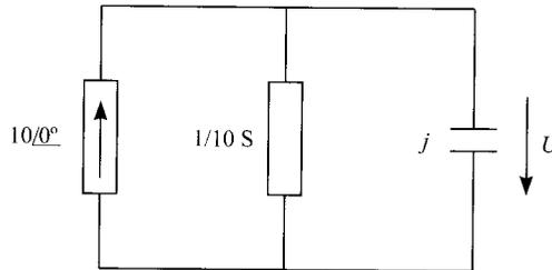
Puesto que se trata de un circuito paralelo, se muestran en la figura las admitancias de los elementos. La tensión en el condensador será:
