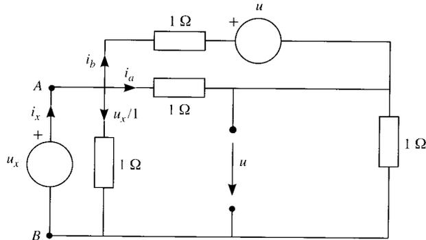
Los valores de  $i_a$  e  $i_b$  se pueden obtener aplicando el método de mallas al circuito equivalente:
