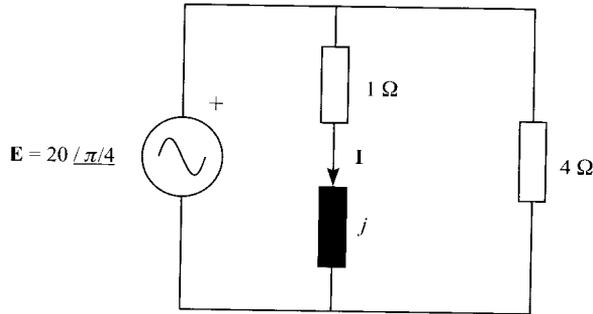
El fasor de corriente en este circuito de alterna tiene el siguiente valor:
