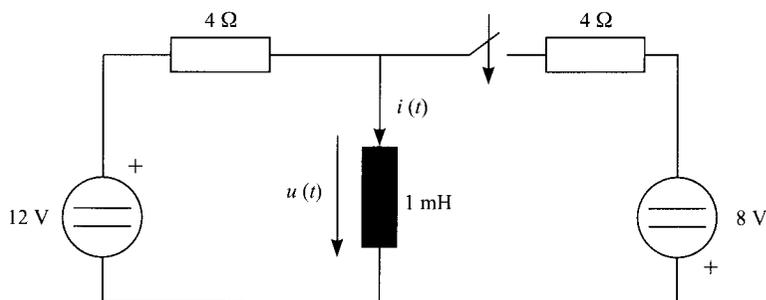
En este circuito, la constante de tiempo, y la corriente inicial de la bobina tendrán el mismo valor que en el primer caso. Sólo es necesario hallar, pues, la corriente en régimen permanente, que se obtiene de la resolución del circuito siguiente:
