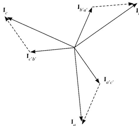
En él, el origen de fases sigue estando en  $E_{ca}$ . Las corrientes de fase por los triángulos están adelantadas  $30^\circ$  con respecto a las corrientes de línea, y tienen una magnitud  $\sqrt{3}$  veces menor. Por tanto:
