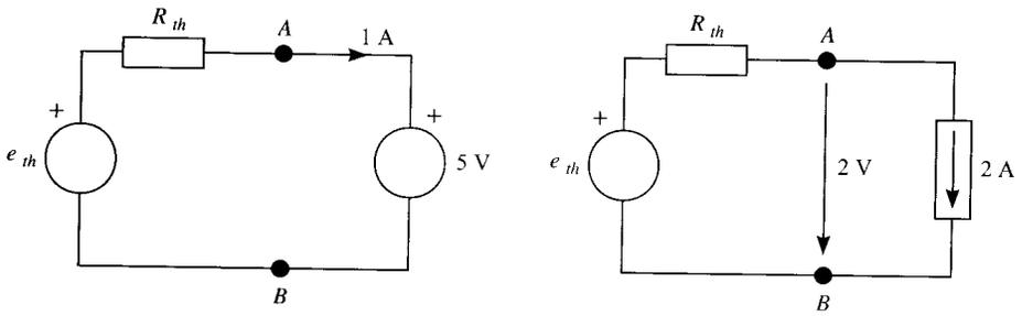
Para determinar el equivalente Thévenin del circuito activo se deben obtener el valor de la fuente de tensión  $e_{th}$  y la resistencia Thévenin,  $R_{th}$ .
