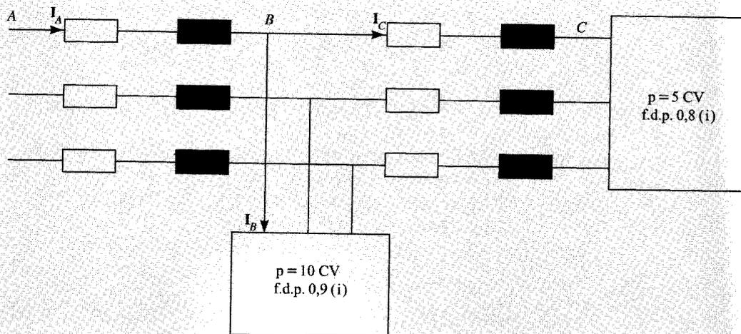
Nota: 1 CV = 736 W. Frecuencia  $f = 50 \text{ Hz}$ .
