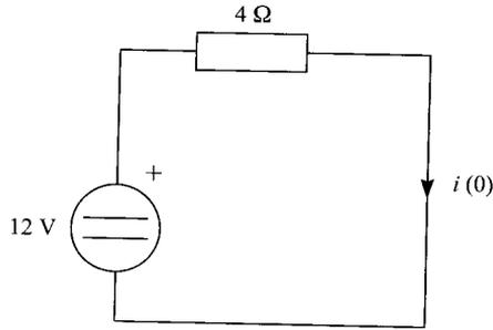
En cuanto al valor final de la corriente, se obtendrá del circuito siguiente, en el que la bobina se ha sustituido por un cortocircuito.
