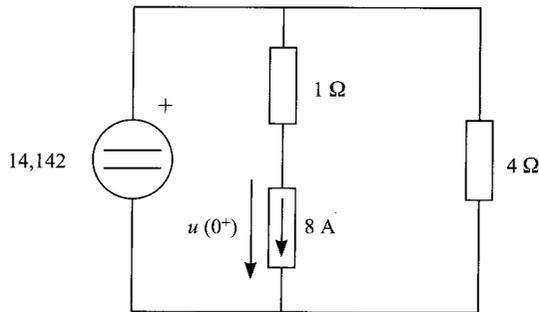
En este circuito, la fuente de tensión representa el valor de la fuente de tensión de alterna en  $t = 0$ , en tanto que la fuente de corriente representa la corriente circulante por la bobina antes de la maniobra,  $i(0^-) = i(0^+)$ .
