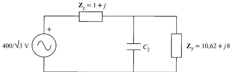
La impedancia equivalente de la carga 1 es la tercera parte del valor de la original, conectada en triángulo, puesto que es su impedancia equivalente en estrella.
