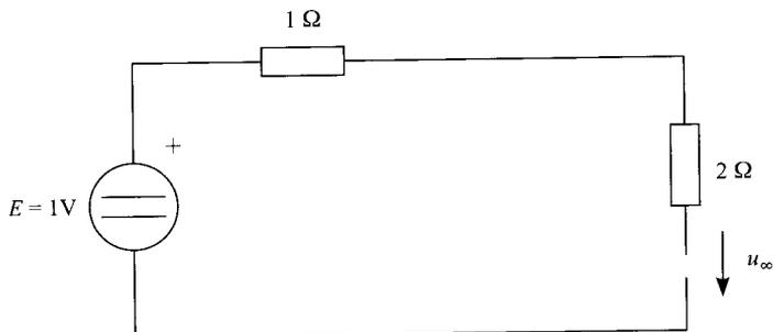
La tensión en régimen permanente  $u_{\infty}$  coincidirá con la tensión en la fuente, al no circular ninguna corriente por el circuito abierto, esto es,  $u_{\infty} = E = 1 \text{ V}$ .
