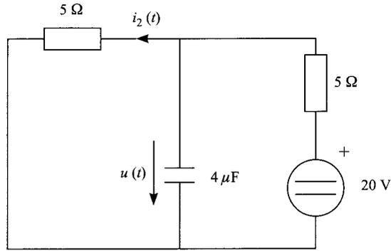
Puesto que en este circuito el condensador y la resistencia de  $5\ \Omega$  están en paralelo, la corriente  $i_2$  será igual a:
