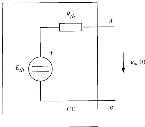
En este caso, la tensión en régimen permanente en el condensador coincide con el valor de la fuente del equivalente Thévenin, es decir,  $u_{\infty} = u_{\infty}(0) = 10 \text{ V}$ . Por tanto, la tensión en el condensador será:
