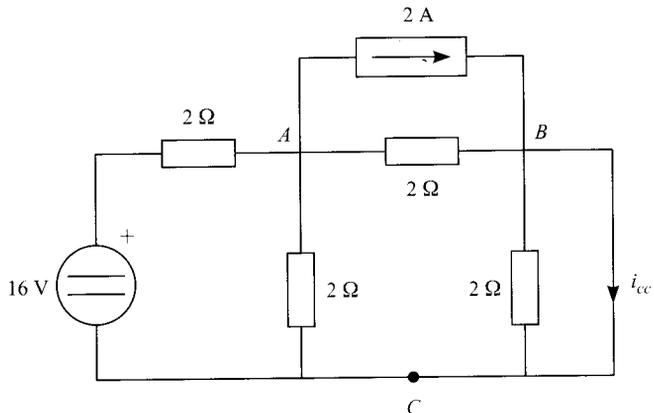
La corriente de cortocircuito se obtendrá también aplicando el método de superposición. Cuando sólo actúa la fuente de corriente se obtiene el circuito siguiente:
