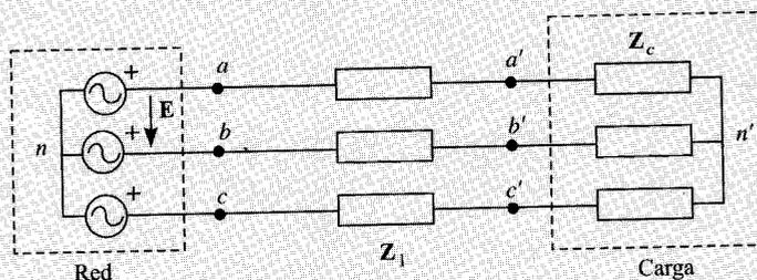
Cuando la tensión aplicada a la carga es de 400 V, consume una potencia activa  $P = 12,8 \text{ kW}$  y una potencia reactiva  $Q = 9,6 \text{ kVAR}$ .
