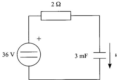
En este circuito, la constante de tiempo será  $\tau = 2 \cdot 3 \cdot 10^{-3} = 6$  ms. La tensión en régimen permanente del condensador coincidirá con la tensión en la fuente, es decir,  $u_{\infty} = 36$  V. Por tanto, la tensión en el condensador será:
