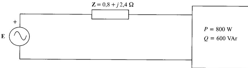
La diferencia entre la potencia activa generada por la fuente y la potencia activa consumida por la carga es la potencia consumida por la impedancia  $\mathbf{Z}$ :
