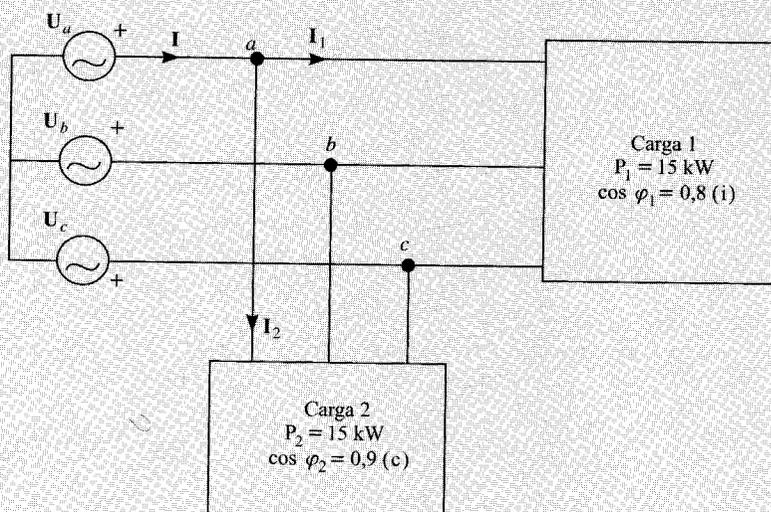
Datos:  $U_a = 400/\sqrt{3}/0^\circ$ ; frecuencia  $f = 50$  Hz.
