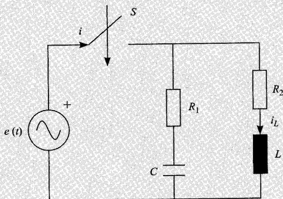
1. Calcúlense las expresiones de la tensión  $u_C$  y de la corriente  $i_L$  para  $t \geq 0$ .
